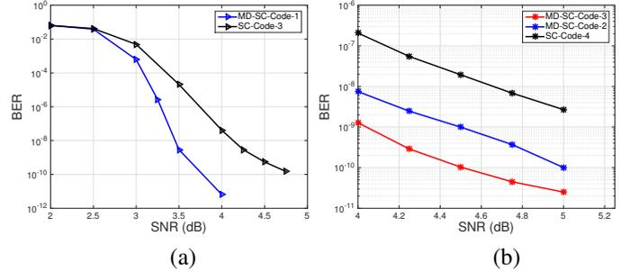
Fig. 2: The BER performance comparison for: (a) MD-SC-Code-1 and SC-Code-3 (b) MD-SC-Code-2, MD-SC-Code-3, and SC-Code-4.
